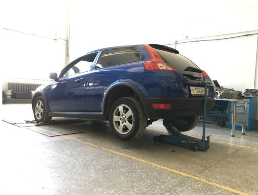
Рис. 1. Измерение веса передней оси Volvo C30 под нагрузкой
