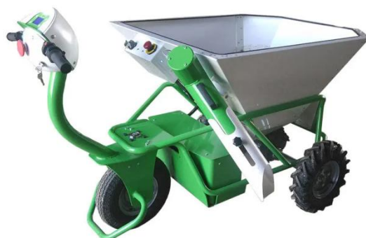
Рис. 2. Малогабаритный кормораздатчик «Alicatt E-301» [3]
