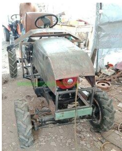
Рис. 3. Общий вид полноприводного мини-трактора с цельной рамой
