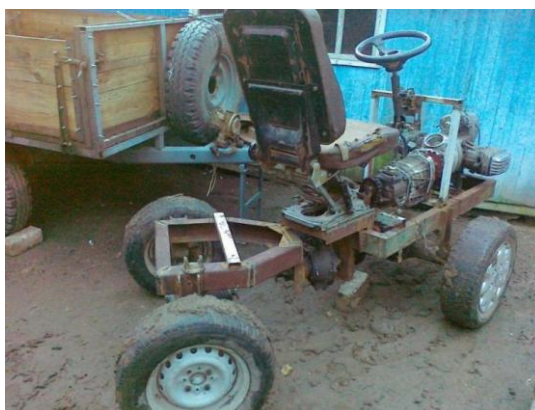
Рис. 2. Общий вид полноприводного мини-трактора-переломки
