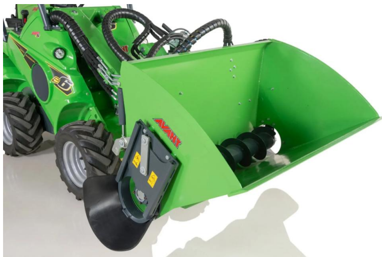
Рис. 2. Ковш для зерен A43 series
