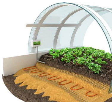
Рис. 3. Схема установки нагревательных кабелей по слою теплоизоляции из пеноплекса
