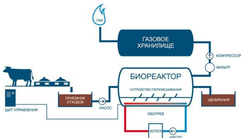
Рис. 1. Технологическая схема переработки навоза
