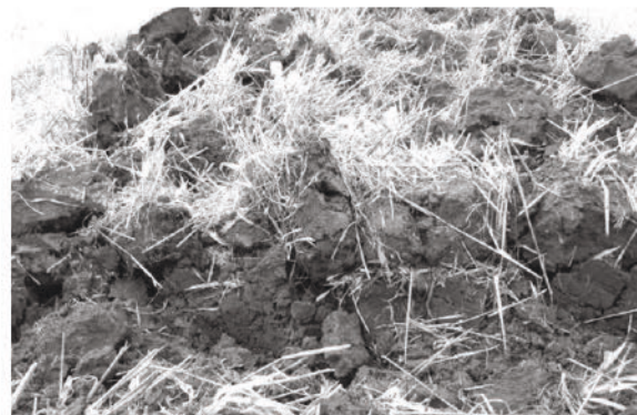
Рис. 3. Почвенный срез на глубину обработки после прохода плоскорезущих лап и дисковой секции: а – \alpha = 10^\circ ( x_1 ), N = 80 кг ( x_2 ), l = 270 мм ( x_3 ); б – \alpha = 30^\circ ( x_1 ), N = 240 кг ( x_2 ), l = 360 мм ( x_3 ) Fig. 3. Soil cut to the processing depth after the passage of the flat-cutting paws and the disk section: а – \alpha = 10^\circ ( x_1 ), N = 80 kg ( x_2 ), l = 270 mm ( x_3 ); б – \alpha = 30^\circ ( x_1 ), N = 240 kg ( x_2 ), l = 360 mm ( x_3 )
