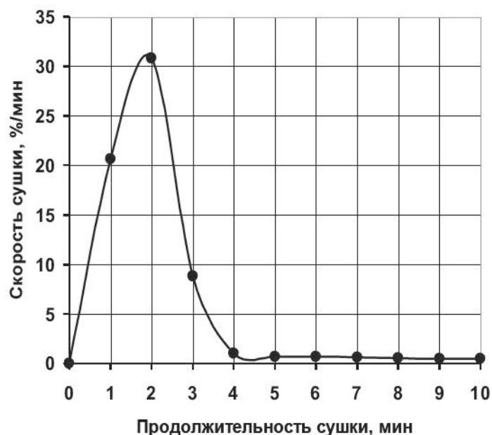
Рис. 2. Изменение скорости обезвоживания листьев кориандра в процессе СВЧ-вакуумной сушки Fig. 2. Change in drying rate of coriander leaves during microwave-vacuum drying
