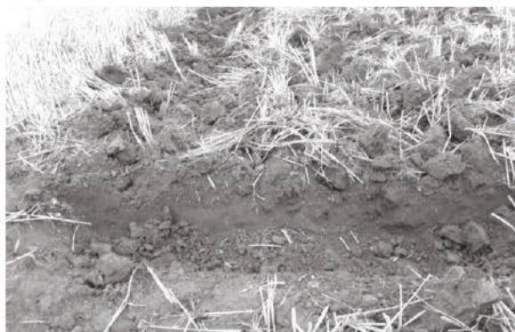
Рис. 3. Почвенный срез на глубину обработки после прохода плоскорезущих лап и дисковой секции: а – \alpha = 10^\circ ( x_1 ), N = 80 кг ( x_2 ), l = 270 мм ( x_3 ); б – \alpha = 30^\circ ( x_1 ), N = 240 кг ( x_2 ), l = 360 мм ( x_3 ) Fig. 3. Soil cut to the processing depth after the passage of the flat-cutting paws and the disk section: а – \alpha = 10^\circ ( x_1 ), N = 80 kg ( x_2 ), l = 270 mm ( x_3 ); б – \alpha = 30^\circ ( x_1 ), N = 240 kg ( x_2 ), l = 360 mm ( x_3 )
