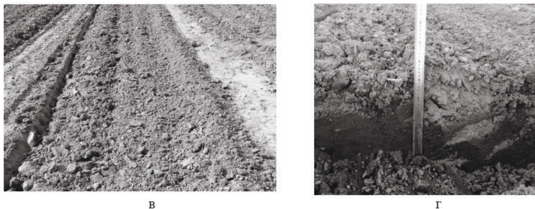
Рис. 5. Вид участка (а, в) и почвенный срез (б, г) после обработки культиваторными лапами и дисковой секцией: а, б – \alpha = 10^\circ ( x_1 = -1 ), N = 160 кг ( x_2 = 0 ), l = 360 мм ( x_3 = 1 ); в, г – \alpha = 20^\circ ( x_1 = 0 ), N = 160 кг ( x_2 = 0 ), l = 270 мм ( x_3 = 0 )
