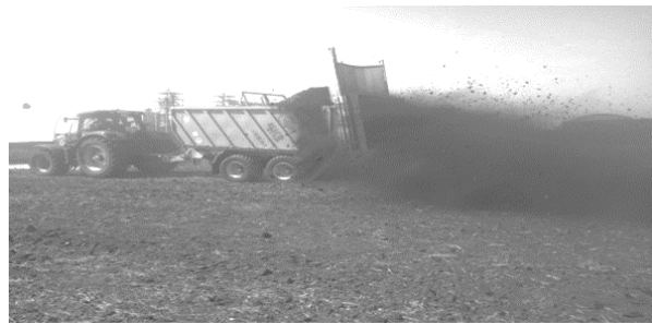
Рис 2. Технологический процесс разбрасывания удобрений агрегатом в составе трактора Case Puma 210 и полуприцепа ПТВ – 256
