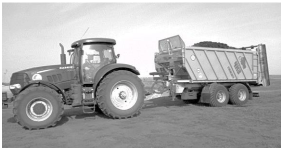
Рис 1. Общий вид агрегата в составе трактора Case Puma 210 и машины для разбрасывания органических удобрений на базе полуприцепа ПТВ – 256
