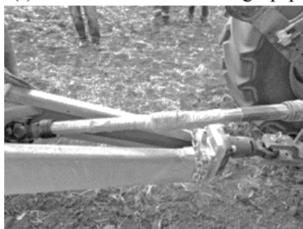
Рис 4. Измерение крутящего момента на карданном валу
