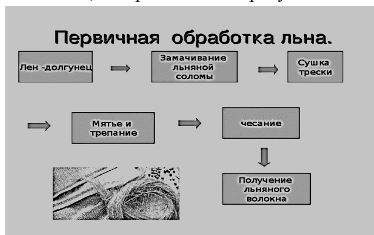
Рисунок 2. Технологический процесс получения льноволокна.
