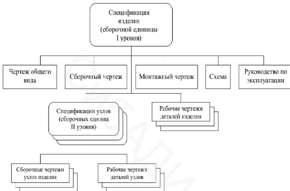
Рис.6. Пример комплектности конструкторской документации
