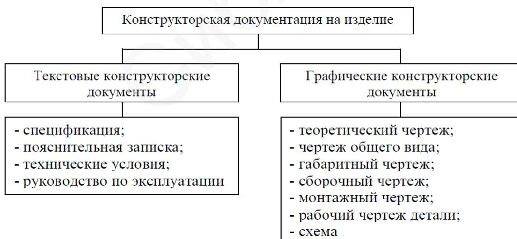
Рис. 5. Типовой состав конструкторских документов на изделие
