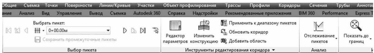
Рис. 4.16. Панель инструментов для работы с группой пикетов или заданного пикета проектного коридора
