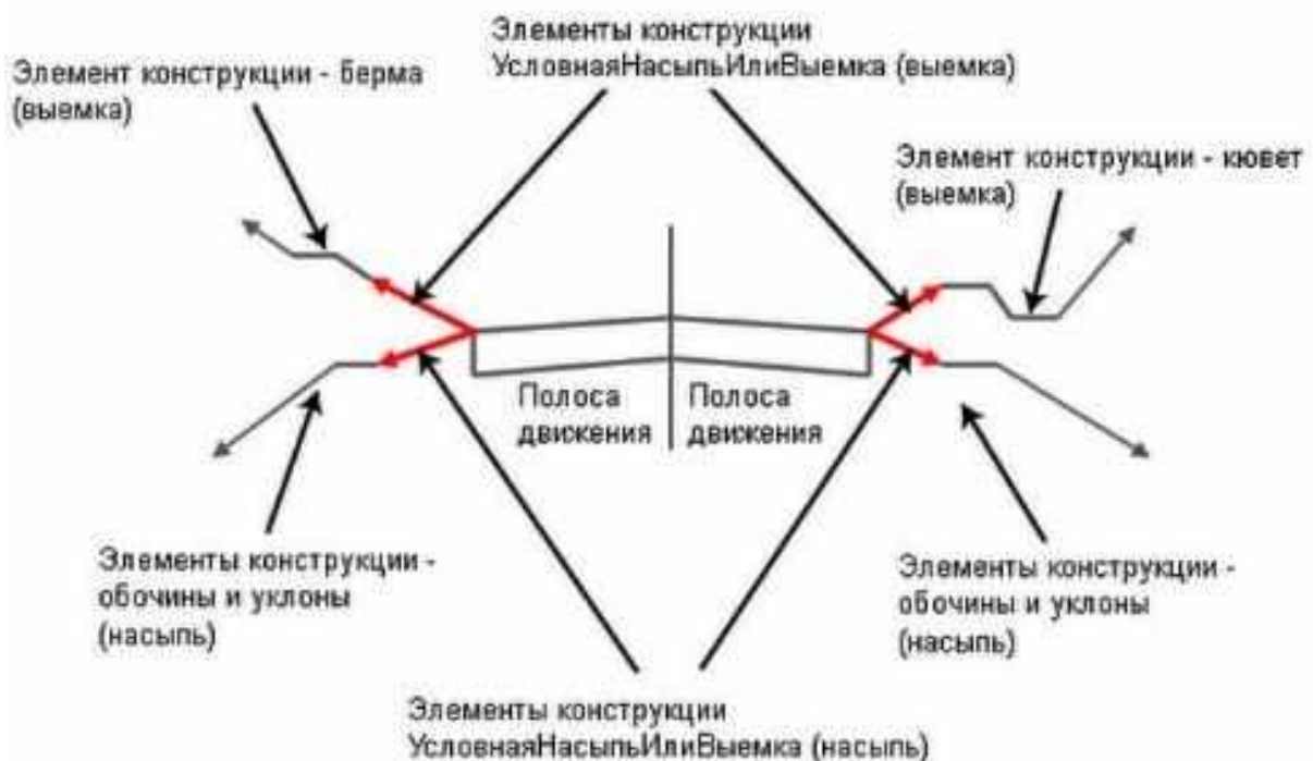
Рис. 4.6. Элементы конструкции «УсловнаяНасыпьИлиВыемка»
