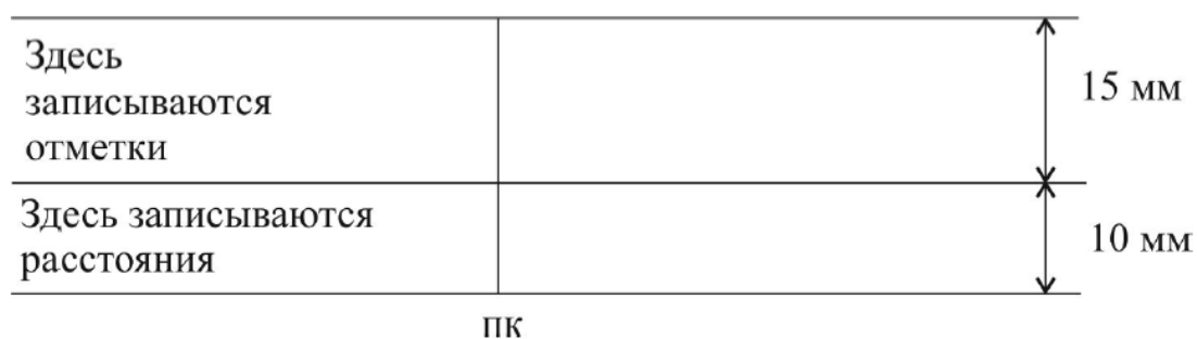
Рисунок 19 – Схема для построения поперечника
