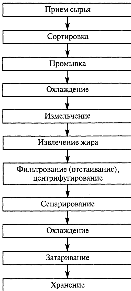
Рисунок 18 – Технологическая схема переработки мягкого жирсырья
