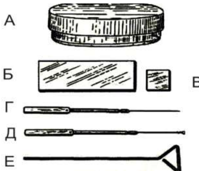
Рис. 4. Микробиологическая посуда: А – чашка Петри, Б – стекло предметное, В – стекло покровное, Г – игла микробиологическая, Д – петля микробиологическая, Е – шпатель Дригальского
