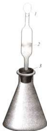
Рис.10. Прибор для культивирования денитрифицирующих бактерий [20]. 1 – ватная пробка; 2 – слой вазелинового масла; 3 – каучуковая пробка.
