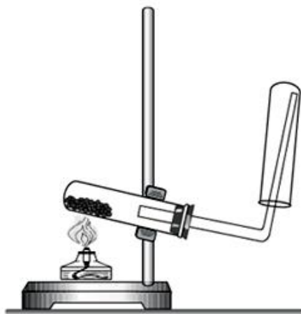
Рис.4. Получение аммиака методом вытеснения воздуха газом, который легче воздуха
