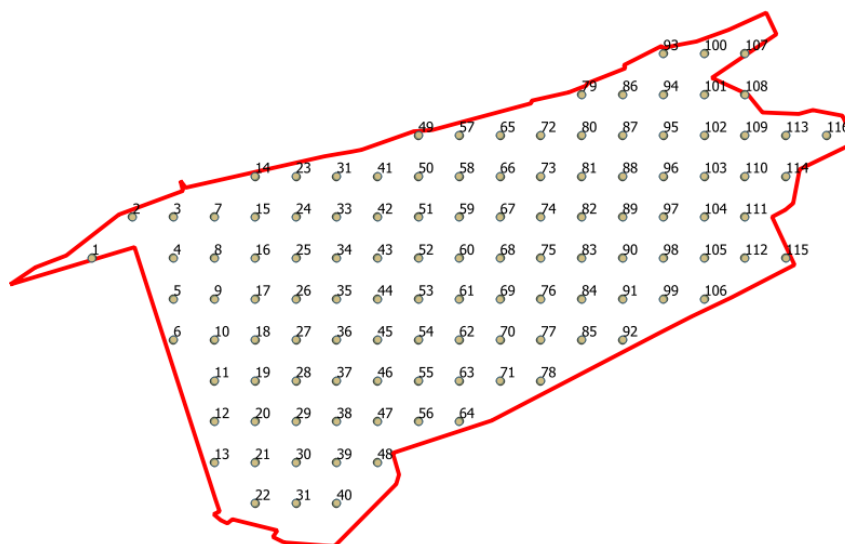
Рис. 23. Картографическая основа для проведения магнитометрической съемки почвенного покрова на территории левобережной части г. Перми
