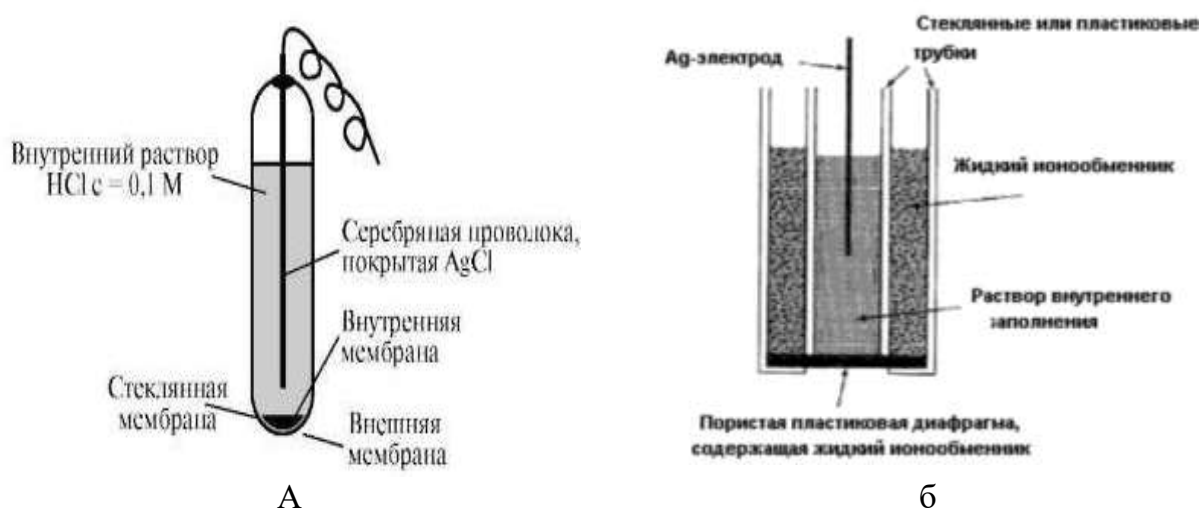
Рис. 26. Электроды с твердой (а) и с жидкой (б) мембраной
