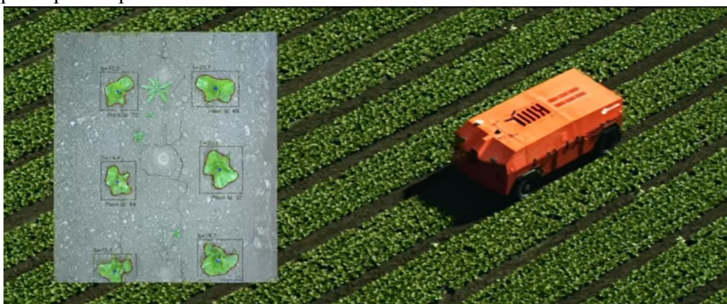
Рис. 3. Робот FarmWise в поисках сорной растительности
