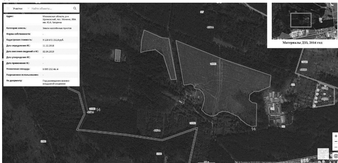
Рисунок 1. Применение данных ДЗЗ и ПКК для выявления нарушений в использовании земельного участка
