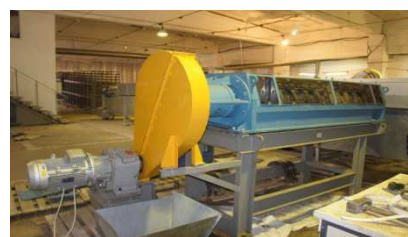
Пресс шнек производительностью 800 кг/ч с обезвоживанием дробины до 65%
