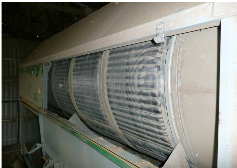
Рис.2. Сепаратор зерна с цилиндрическим решетом, реализующим вторую ступень предварительной его очистки
