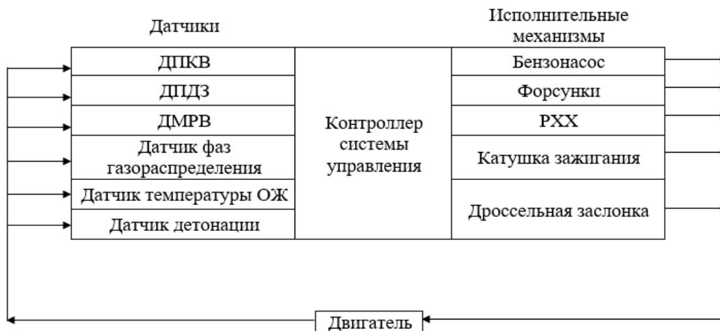
Рис. 1 Структура системы управления
