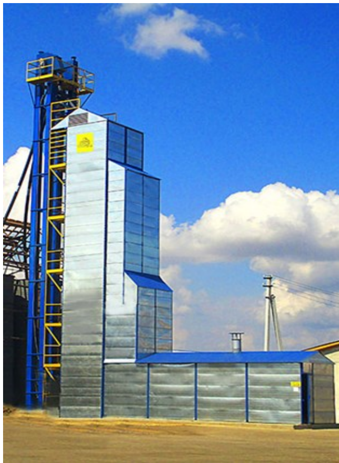
Рис. 5 Общий вид поточной колонковой зерносушилки сотового типа
