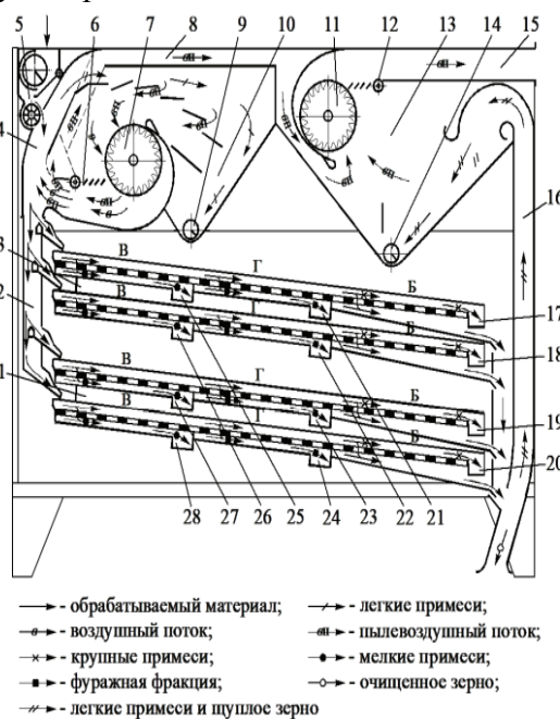
Рис. 3. Схема сепаратора вороха СВУ-60: 1, 3 – решетные станы; 2 – распределительное устройство; 4, 16 – ПСК; 5 –питающее устройство; 6, 12 – регулятор скорости воздушного потока; 7, 11 - вентиляторы; 8 – воздушный рециркуляционный канал; 9, 14 – шнеки; 10, 13 – осадочные камеры; 15 – выхлопной патрубок; 17...28 – лотки вывода фракций.
