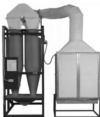
Рис. 2. Пылеуловитель рукавного типа
