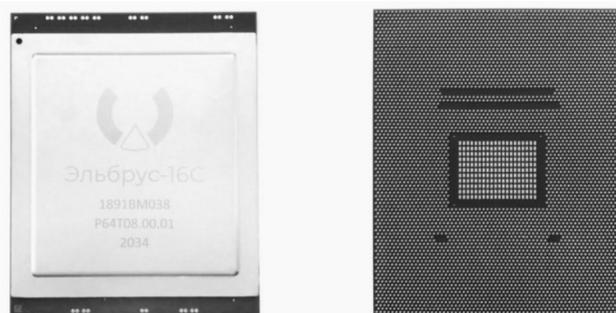
Рисунок 1. Микропроцессор Эльбрус – 16С
