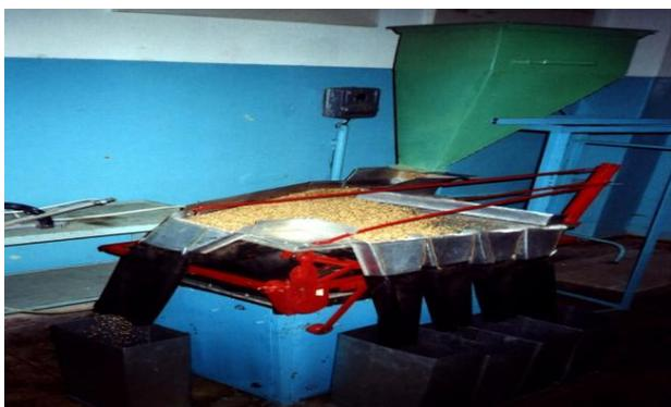
Рисунок 10 – Экспериментальный образец вибропневмосепаратора семян производительностью 0,5 т/ч
