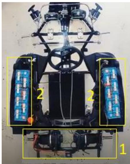
Рисунок 2 – Компоновка карта RIMO SINUS ION
