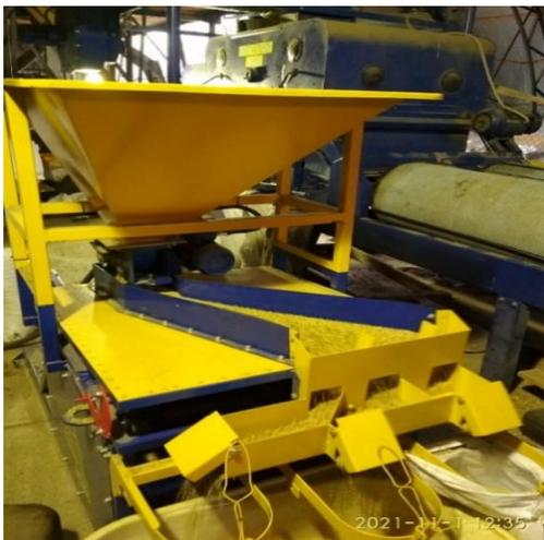
Рисунок 12 – Производственные испытания вибропневмосепараторов производительностью 2,5 т/ч
