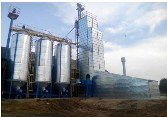
Рисунок 7 – Агрегат для двухэтапной технологии сушки зерна семян, выпускаемый ООО «Техноград»
