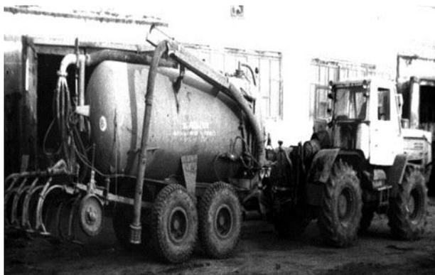
Рисунок 2 – Экспериментальный образец машины для внутрпочвенного внесения жидких органических удобрений
