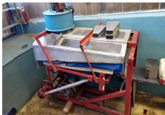
Рисунок 11 – Экспериментальный образец вибропневмосепаратора семян производительностью 1,0 т/ч
