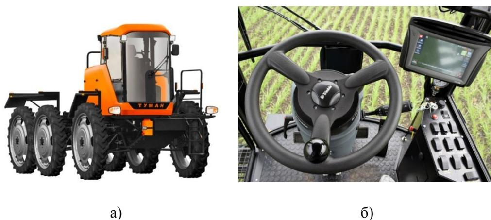
Рисунок 2 – а – мобильный, самоходный агрегат комплекса «Туман...»; б – оборудование кабины для управления агрегатом и технологическим процессом
