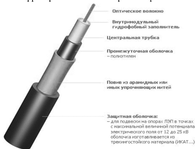
Рисунок 1. Конструкция оптического кабеля марки ИКА
