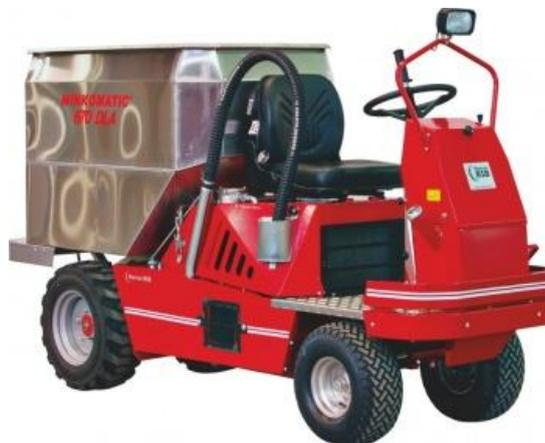
Рис. 6. Малогабаритный кормораздатчик «Minkomatic 670» [2]
