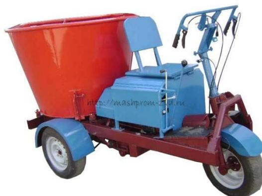
Рис. 3. Малогабаритный кормораздатчик «МАШПРОМ» [6]
