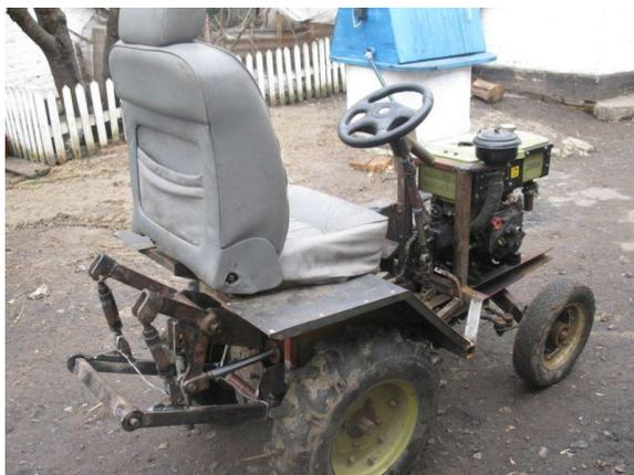
Рис. 1. Общий вид мини-трактора с задним приводом
