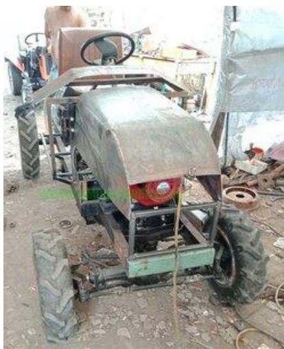
Рис. 3. Общий вид полноприводного мини-трактора с цельной рамой
