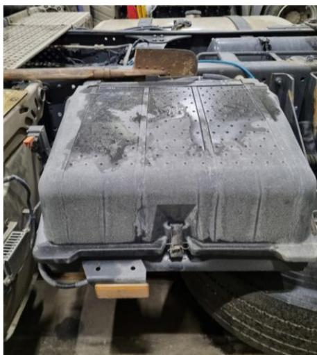
Рис. 1. Расположение аккумуляторных батарей и блока выключателя массы
