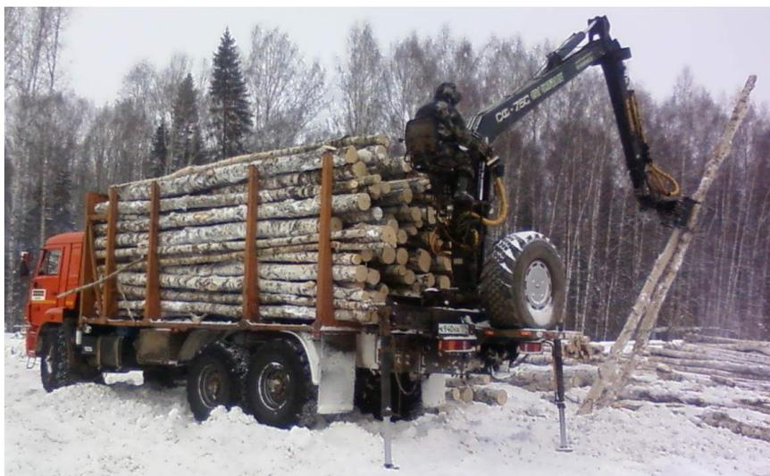
Рис. 1. Процесс погрузки лесозаготовок в автомобиль
