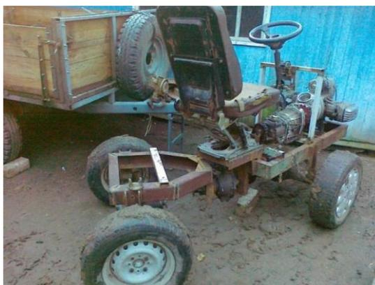
Рис. 2. Общий вид полноприводного мини-трактора-переломки
