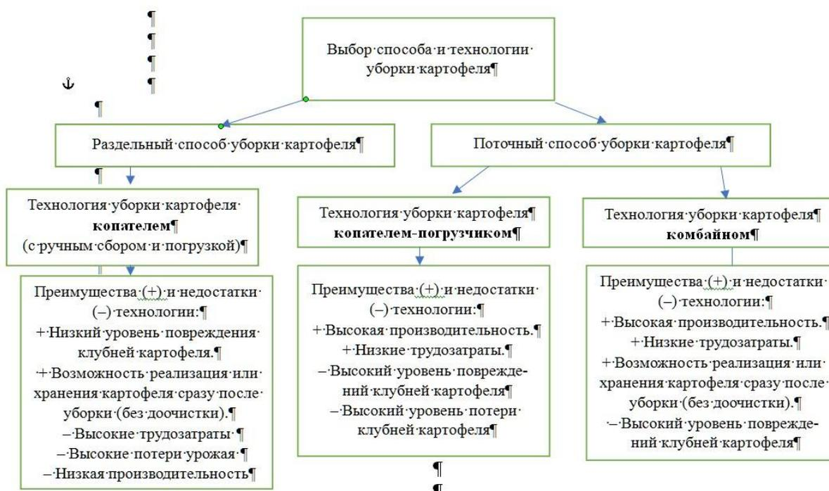
Рис. 1. Основные способы и технологии механизированной уборки картофеля
