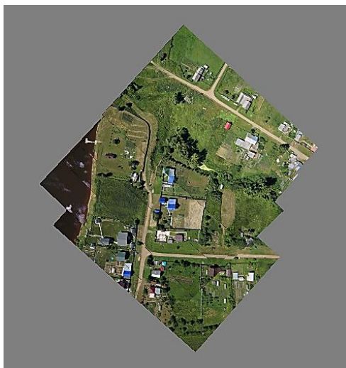
Рис. 7. Сшитый снимок (ортофотоплан)
