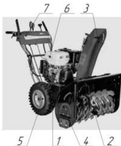
Рисунок. Основные части снегоуборочной машины бытового назначения: 1 – моторный узел; 2 – винтовой шнек; 3 – экран; 4 – защитный кожух; 5 – шасси; 6 – топливный бак; 7 – органы управления
