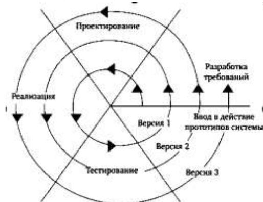
Рисунок 1. спиралевидная модель разработки
