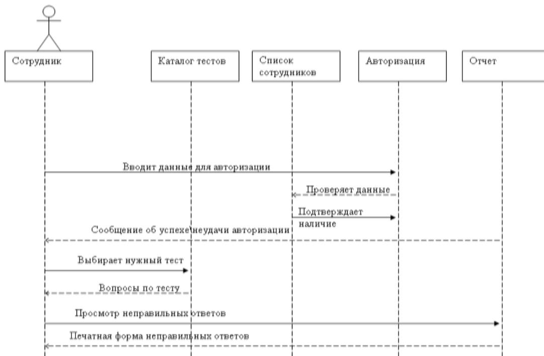
Рисунок 1. Диаграмма последовательности «Пройти тестирование»
