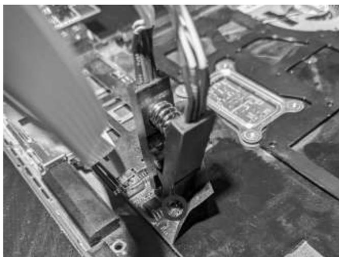
Рисунок 2. Установка Coreboot с помощью программатора ch340
