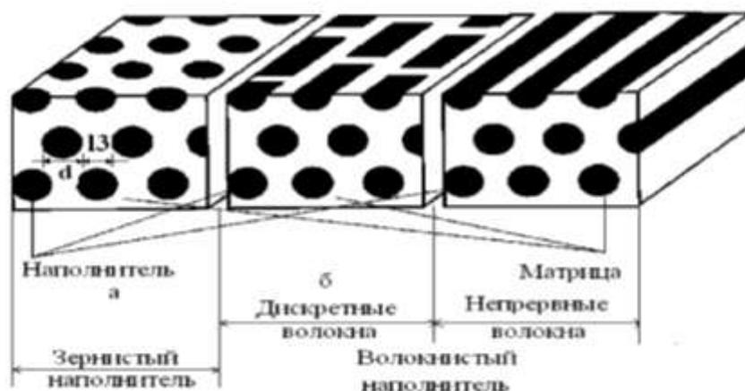
Рисунок 1. Схемы структуры композита
